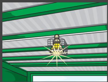
Las instalaciones eléctricas no deben estar expuestas, ni deben tener daños. O bien, deben conducirse en mangueras de polietileno.
