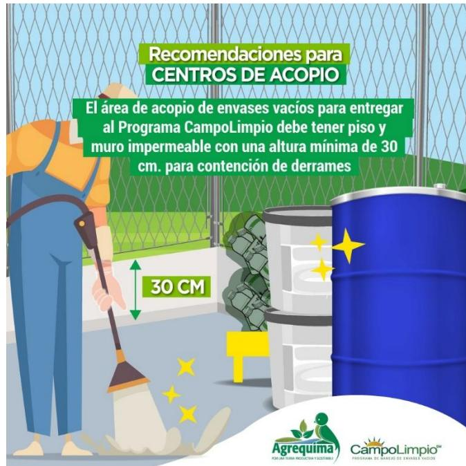
6. La estructura de un centro de acopio de envases vacíos de agroquímicos debe ser resistente a la acción del viento. Se debe garantizar una excelente ventilación del área de construcción, como mínimo el 75 % de los laterales serán establecidos con malla para favorecer la circulación del viento.
