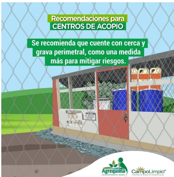
5. El área de acopio de envases vacíos para entregar al programa CampoLimpio, debe tener pisos lisos, impermeables, con un sistema que impida posibles derrames fuera del área de acopio. Las paredes o muros deben ser impermeables con una altura mínima de 30 cms. (para contención de derrames).
