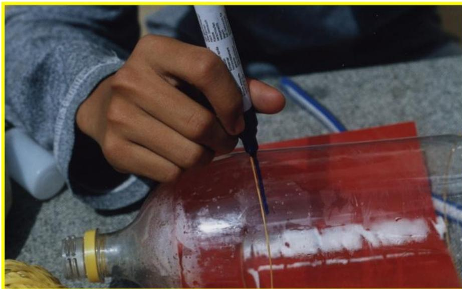
**Paso 1:** Utilice un envase plástico desechable de 2 litros, empleando 2 bandas de hule como guía y un marcador delimite los sitios en que realizará los cortes para eliminar la punta y la base de la botella. La fotografía le ilustra el procedimiento.
